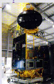
通信放送技術衛星 「かけはし」の熱試験モデル
