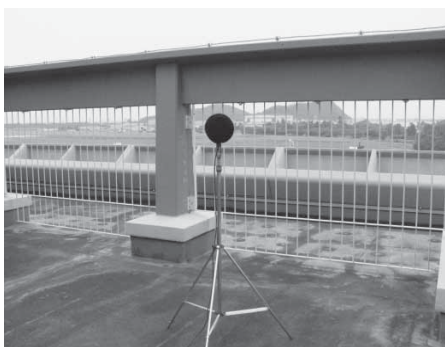
環境騒音測定装置（市役所屋上）
