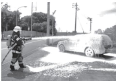
圧縮空気泡消火システムを使用した放水
