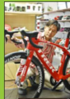
（写真上）ペダルを回してギアの変速調整を行う（下）店舗には、上級者にも納得の品が並ぶ
