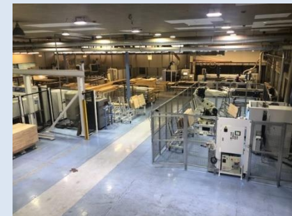
↑加工機でQRコードで読み取った情報を元に加工する
