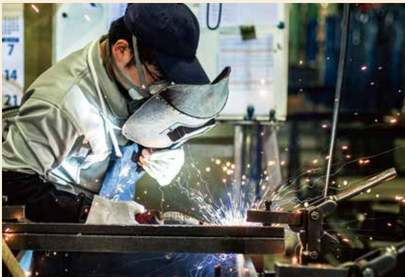
溶接の音で、出来を判断する
