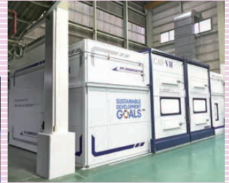
オール電化塗装ブース
